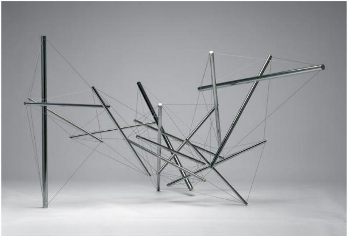
Figure 9: Photographie d'une maquette tensegrité de K.Snelson avec des tiges en compression et des câbles en tension
