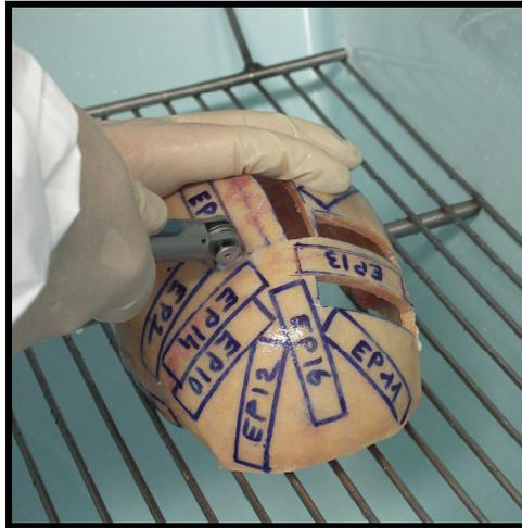
Figure 18: Découpe des éprouvettes à la scie oscillante
