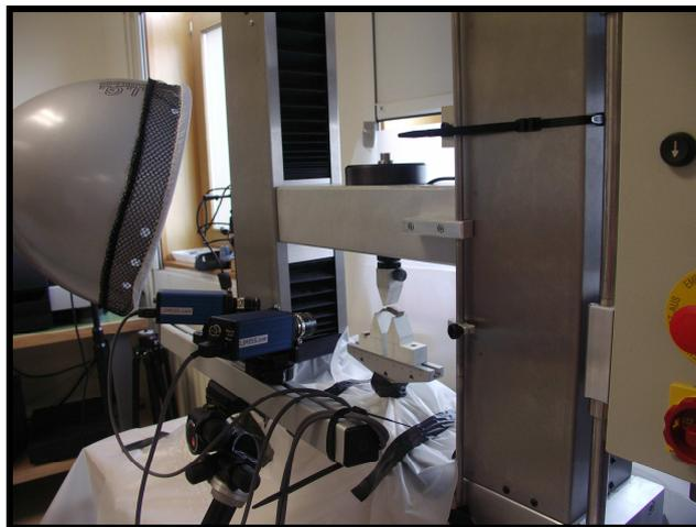
Figure 39: Montage utilisé pour la stéréocorrélation d'images
