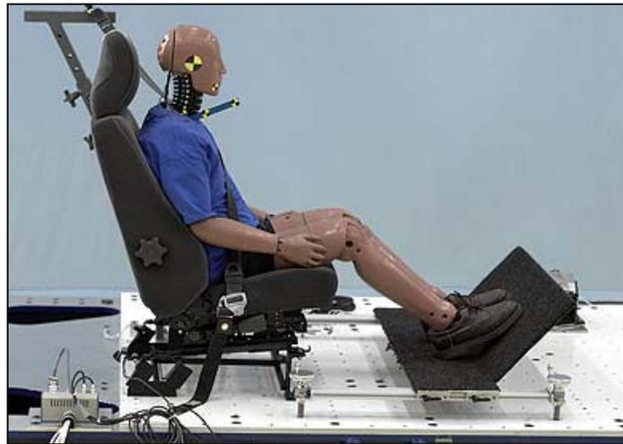
Figure 19 : Mannequin BioRID-II dans sa configuration d'essai
