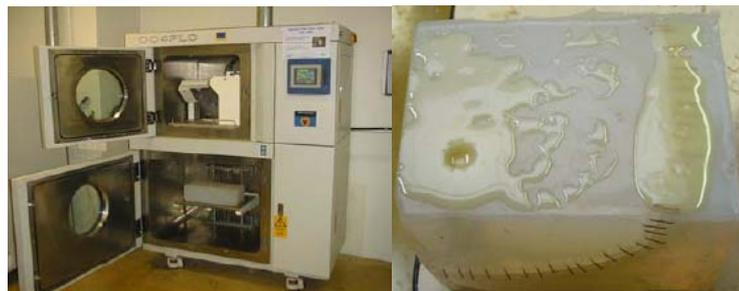
Figure 12 : Machine de coulée sous vide et coulée de l'os pariétal
