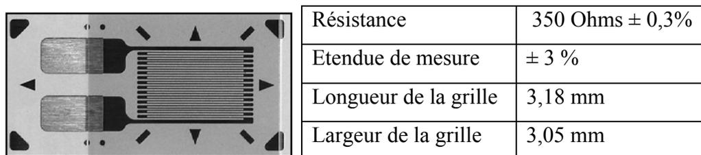
Figure 32 : Caractéristiques techniques des jauges usitées
