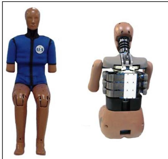
Figure 18 : Vues avant et arrière de l'EuroSID-II
