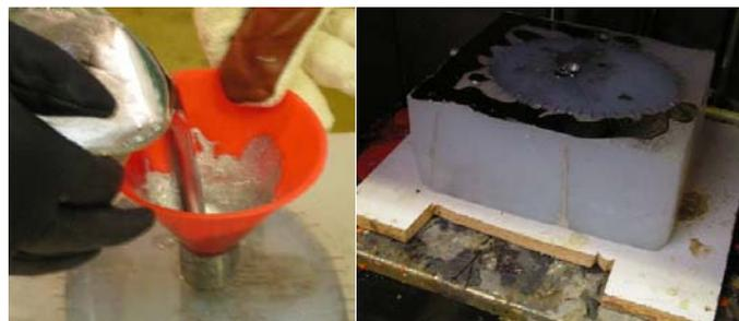
Figure 13 : Coulée manuelle du Cerrobend / Cerrobend coulé placé sous vide
